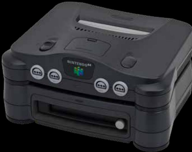
fig 3. Console Nintendo 64 à laquelle est connectée le dispositif N64DD en-dessous. Les disques magnétiques s'insèrent par la fente à l'avant de l'appareil.
