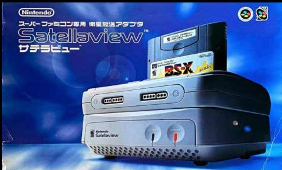
fig 1. Publicité pour le Satellaview, Japon, 1996. Console Super Famicom à laquelle est connectée le dispositif Satellaview en-dessous, ainsi que le Memory Pack au-dessus. Crédits: Muband.
