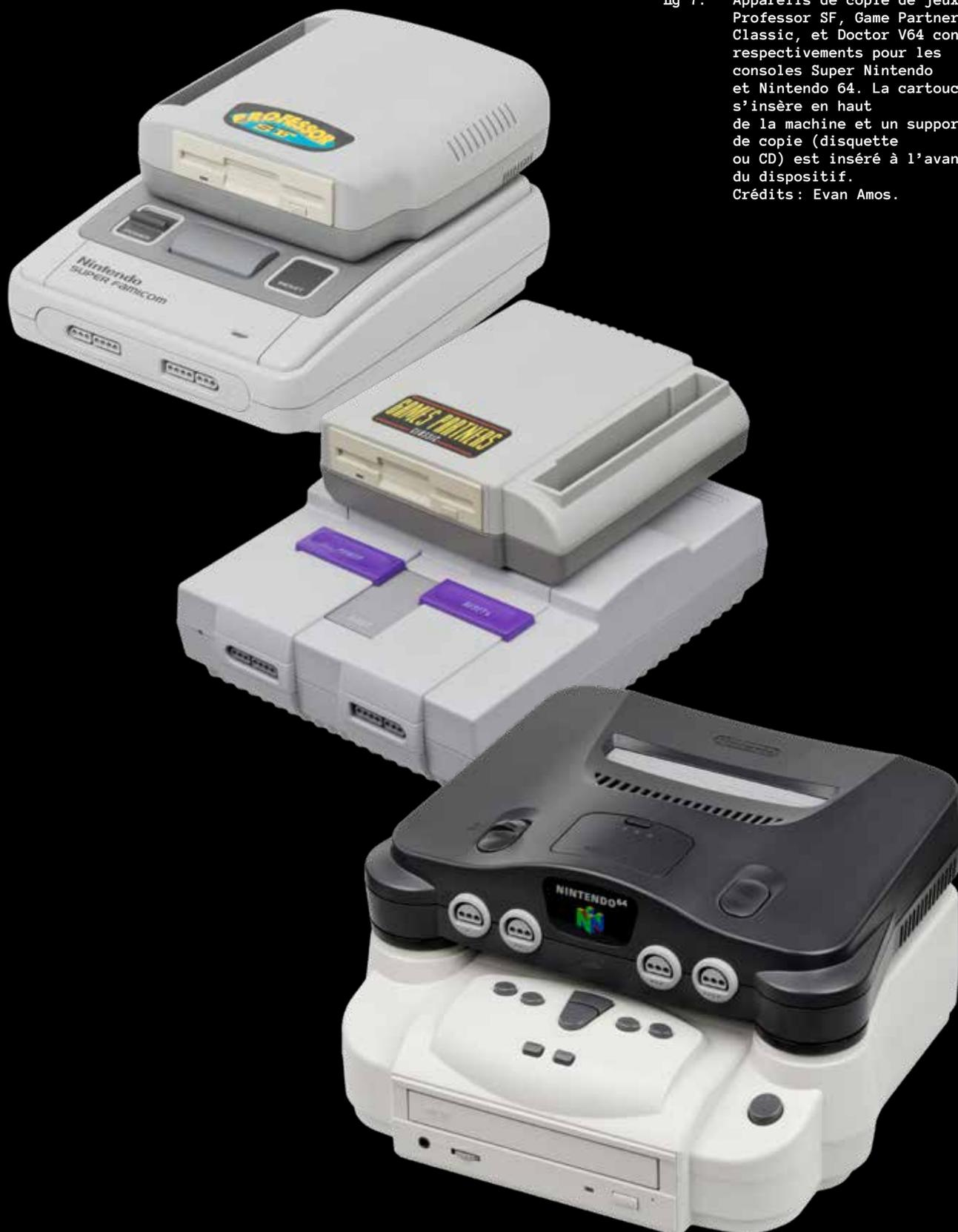
fig 7. Appareils de copie de jeux Professor SF, Game Partners Classic, et Doctor V64 conçus respectivement pour les consoles Super Nintendo et Nintendo 64. La cartouche s'insère en haut de la machine et un support de copie (disquette ou CD) est inséré à l'avant du dispositif. Crédits: Evan Amos.
